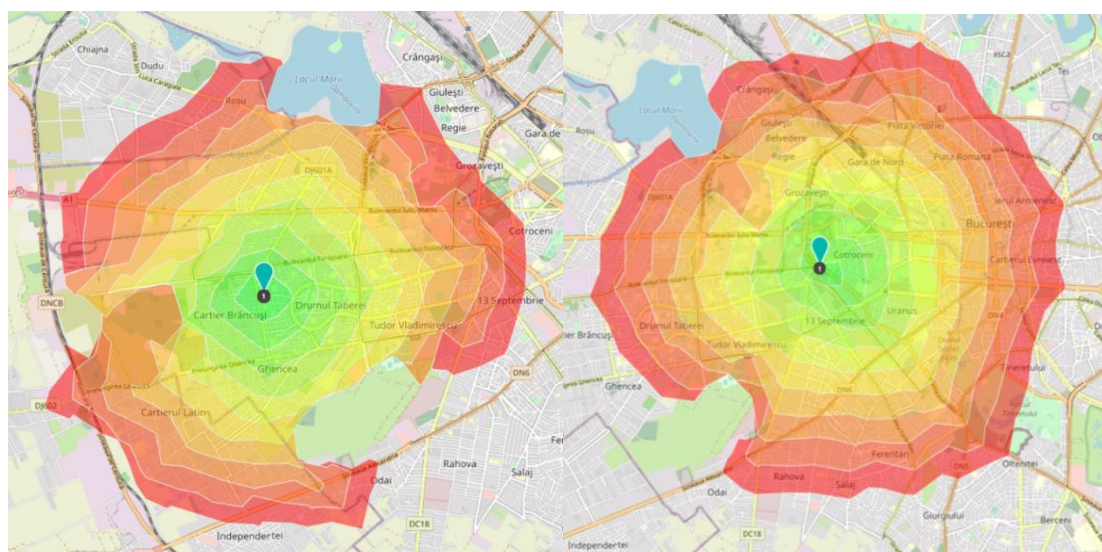
FIGURA 25. Izocrona de accesibilitate pietonală la stațiile Valea Ialomiței și Academia Militară de pe M5 (verde 5 min, galben 30 min, roșu 60 min.)
